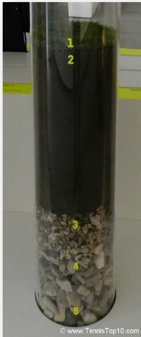
Figura 10 Composición de las canchas de Wimbledon
