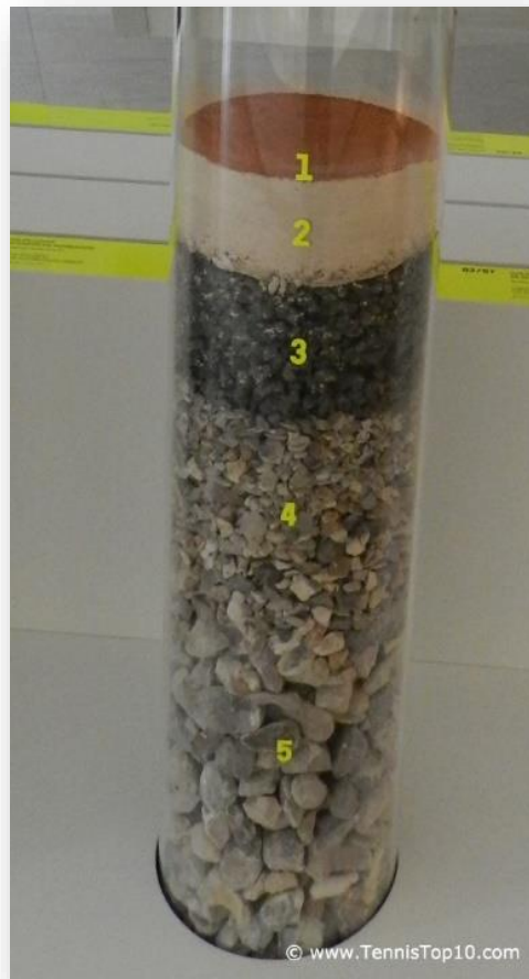
Figura 4 Composición de las pistas de arcilla de Roland Garrós
