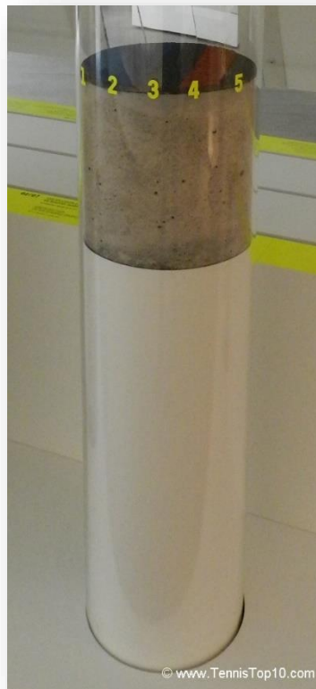
Figura 8 Composición de las pistas del Abierto Australiano
